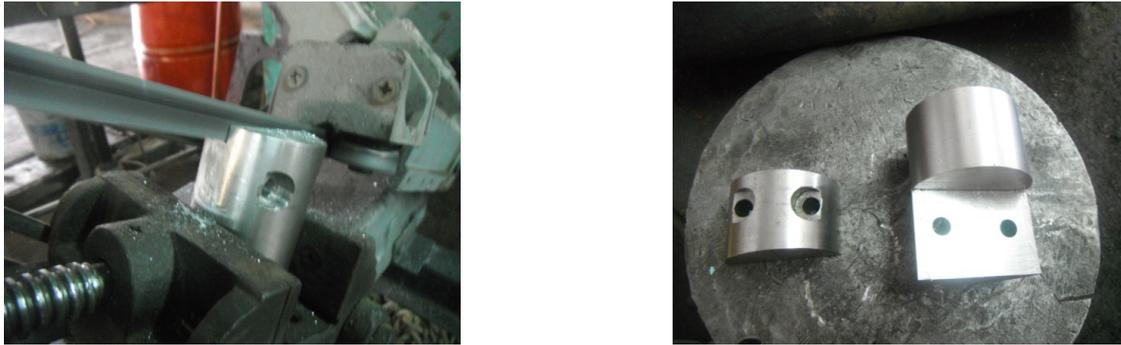
Fig. 5. Maquinado de mordazas para probetas planas material de biopolímero.
