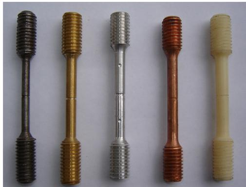
**Fig. 3.** Probetas de diferentes materiales a utilizar en el ensayo de tensión.
